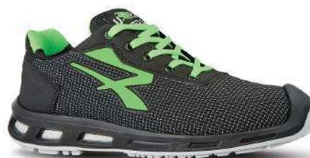
**TOMAIA:** PUTEK® PLUS altamente resistente all'abrasione **FODERA:** WingTex a tunnel d'aria traspirante **PUNTALE:** AirToe Aluminium **ANTIPERFORAZIONE:** Save & Flex® PLUS senza metallo **COPRISOTTOPIEDE:** U-POWER original **INTERSUOLA:** Soffice PU espanso e Infinergy® **CALZATA:** Natural Comfort 11 Mondopoint **MISURE:** DISPONIBILI dalla 38 alla 48
